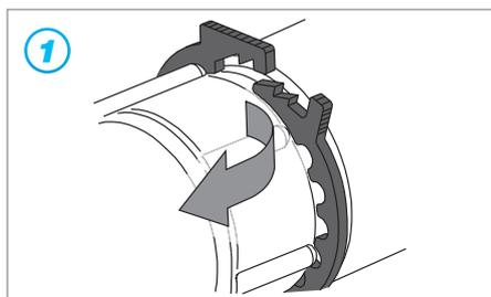
1 Открыть зубчатое зацепление защитного кольца, затем расширить и снять защитное кольцо.
