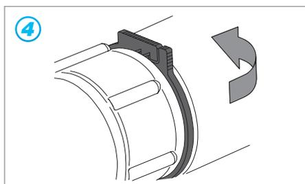
4 Отвести **защитное кольцо** на промежуточное пространство и зафиксировать зубчатое зацепление.
