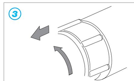
3 Повернуть фитинг ZAK на 90° против часовой стрелки до упора и затем извлечь из муфты ZAK.
